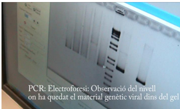
Fig. 22 Observació del resultat final d'una electroforesi
