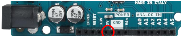
Figura 21: pin d'alimentació 5 volts
