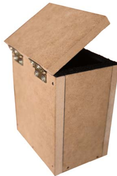
Il·lustració 3.5 Detall de frontisses i perímetre superior. 19
