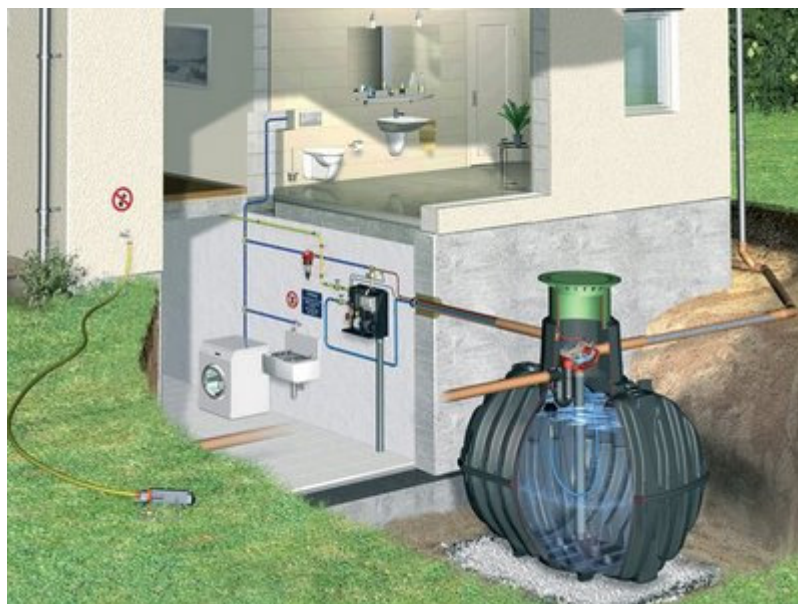
Fig. 4: Instal·lació recuperació aigües pluvials
