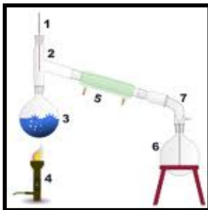
Imatge 8. Diagrama de destil·lació simple.
