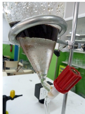
Fig.29 Les dues fases al embut de decantació.
