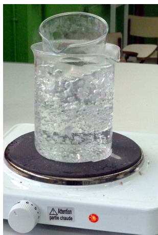
Fig.30 Cloroform bullint a la manta elèctrica.
