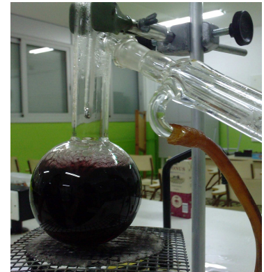
Fig.24 Vi bullint al matràs de destil·lació
