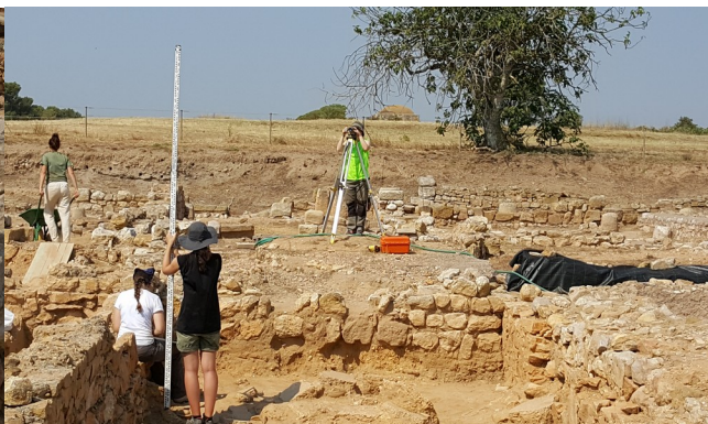
Imatge 17: Foto d'un jaló mètric i d'un nivell a Empúries.
